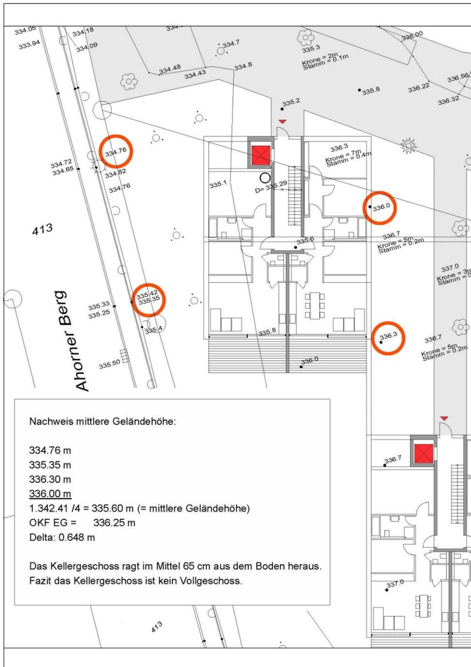
Planausschnitt mit den eingetragenen Vermesserrhöhen und einer Berechnung, welche nachweisen soll, dass das Tiefgeschoss kein Vollgeschoss im Sinne der BayBo Art. 2 ist.
